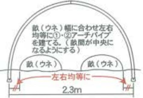
●設置場所に、間口 2.3mと奥行き方向に 1m 間隔で印をし(図 1)、アーチパイプ①・②に埋め込みの部の印(図 2)を付ける。
