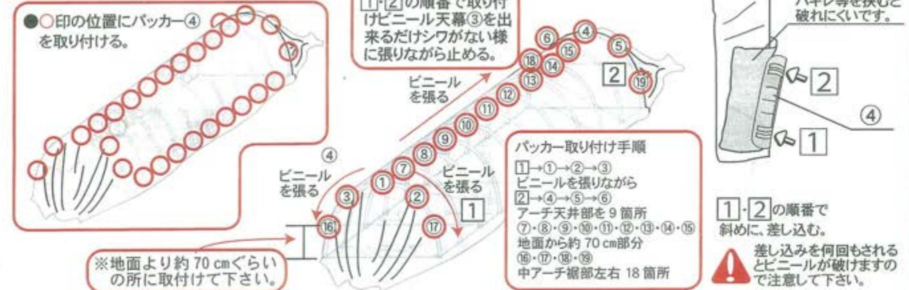
⑤ ラセン杭⑥を骨組み幅の中央部で約 1.5m の位置にねじ込み前後のビニール天幕を集めRバンド⑤で結び止める。
