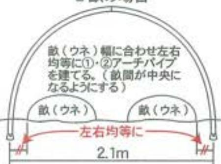
●設置場所に、間口 2.1m と奥行き方向に 1m 間隔で印をし(図 1)、アーチパイプ①・②に埋め込みの部の印(図 2)を付ける。
