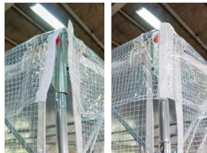
天面同様、横幕生地ハトメにロープが付いています。ロープを使い桁と柱へ結び固定して下さい。固定後天面生地四方、柱上部のマジックテープをかさねます。
