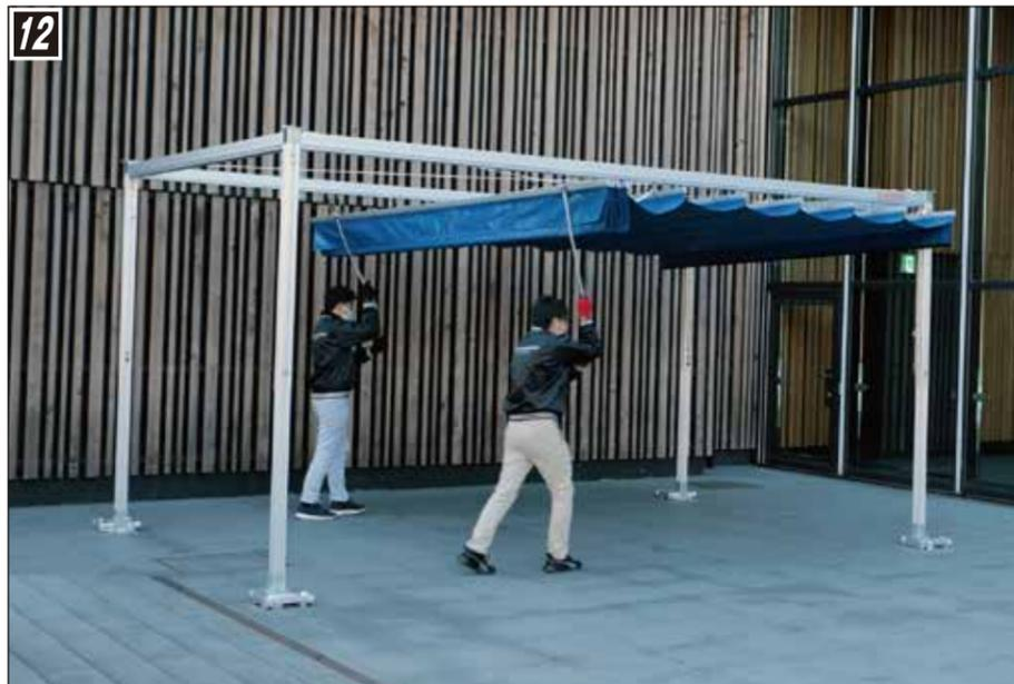
天幕の開閉を行いスムーズに作動するか確認しましょう。天幕の開閉は大人2人で両端の天幕開閉用ベルトを持ち、移動することで開閉します。
