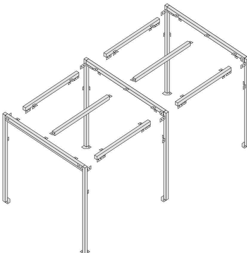
3. 方杖を取り付けます。天井・側面の全ての方杖を仮締めで組付けた後、仮締めで留めていた全てのボルトを本締めします。
