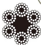
構成6×24 24本線6より中心および 各ストランド中心繊維
