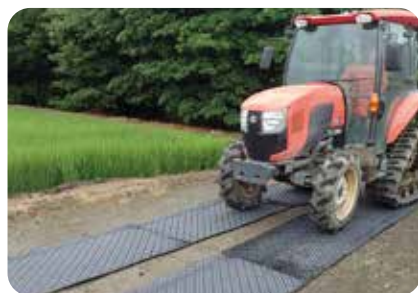
農機走行の路面養生
