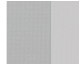
(生地:表) (生地:裏) 3919FP 透光率 14% silver+white シルバー+ホワイト Munsell value(マンセル値) (H)1.71YR(V)7.57(C)0.10
