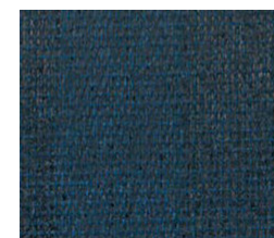
藍 ai 透光率 11% Mansel value(マンセル値) 紫外線カット率 87% (H)3.56PB(V)3.10(C)2.66
