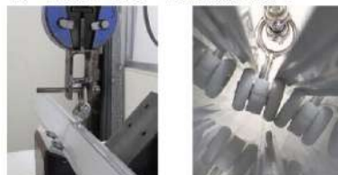
【レール傾斜 ランナー荷重試験の様子】
