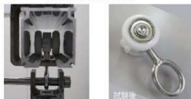
【レール傾斜 ランナー荷重試験の様子】
