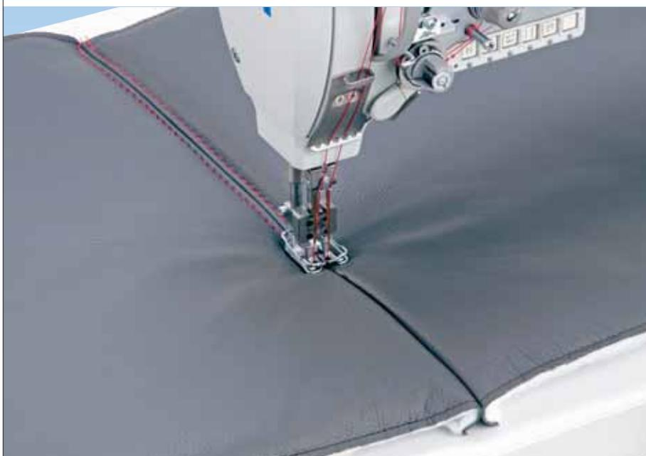
Näheinrichtungen mit Ausgleichfuß und integrierter Nahtmitteführung garantieren ein perfektes Nähergebnis
