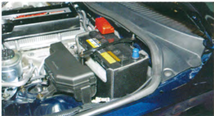
「ダンプレート®」を使用したバッテリーカバー
