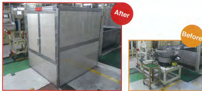
パネル+アルミフレーム別注品 (ボルト用パーツフィーダー騒音対策用)
