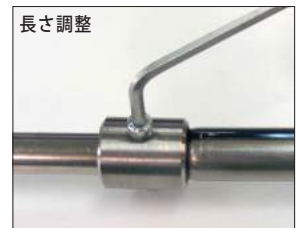
長さ調整 六角ボルトを軽く締めて仮止めし、固定はパイプが変形するまで強く締めてください。
